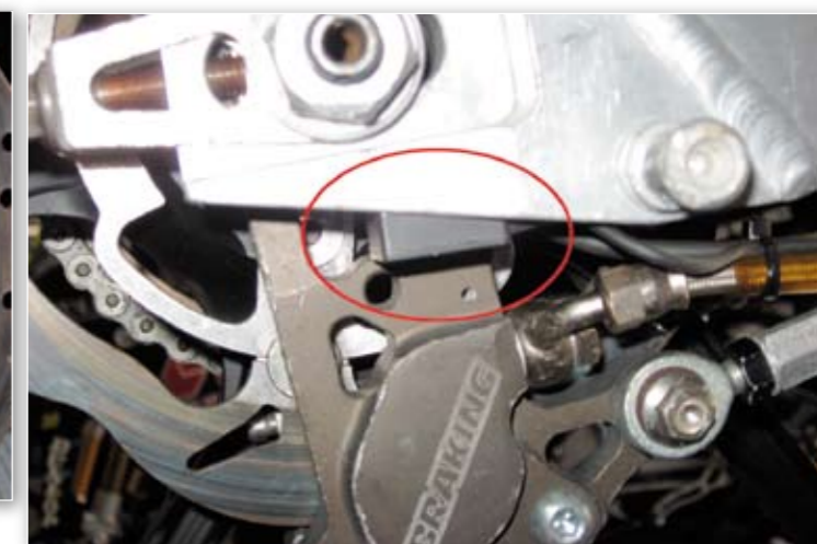
Figura 2, sensori di accelerazione verticale della ruota anteriore e posteriore.
